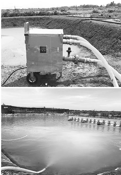
注）写真上：同社のファインバブル発生装置、下：ファインバブル発生装置が稼働中の養殖池（出所）JICA九州センターよりのプレスリリース（2018年9月14日）
