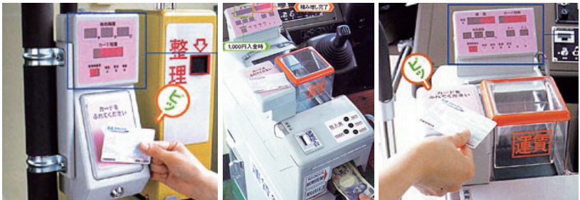
写真3. 長崎スマートカード車内乗車口・降車口設置状況
